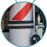
VOORSTE EN ACHTERSTE STEUNVOETEN ZIJN VOORZIEN VAN LED VEILIGHEIDSVERLICHTING
