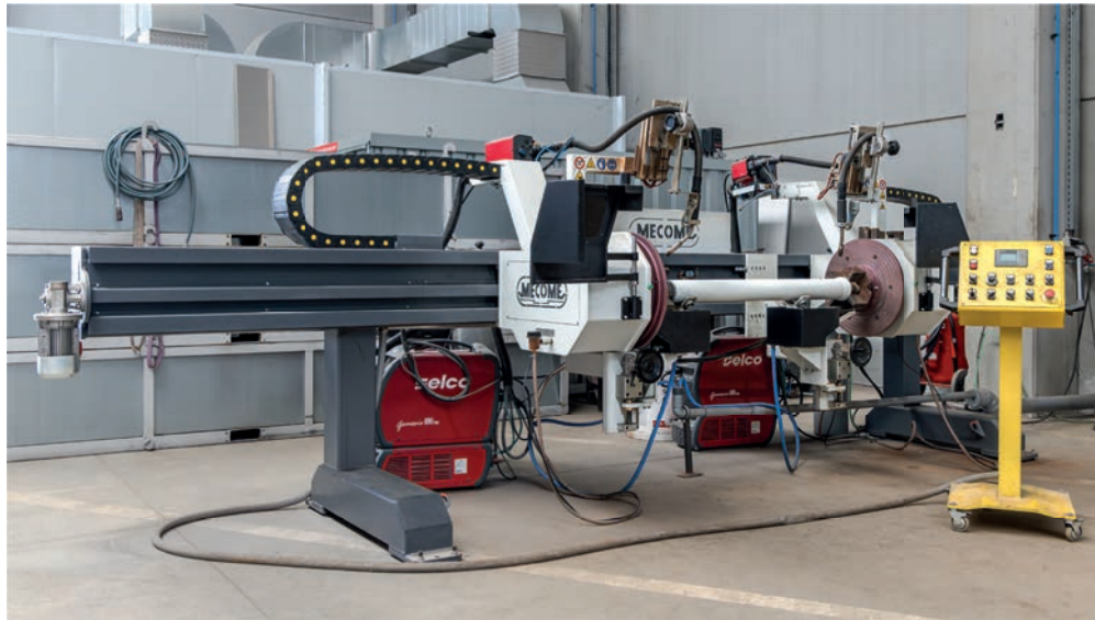
Robot de soudage automatique avec refroidissement pour le soudage des tuyaux en béton à paroi simple et double
