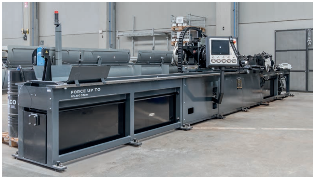
Test - banc de démontage et de montage pour types des vérins hydrauliques
