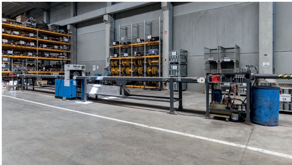
Sertisseuse pour la fabrication sur mesure des tuyaux à béton
