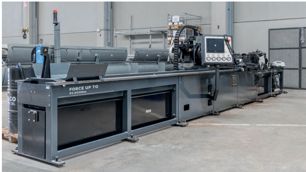
Test - demontage en montage bank voor alle types van hydraulische cilinders
