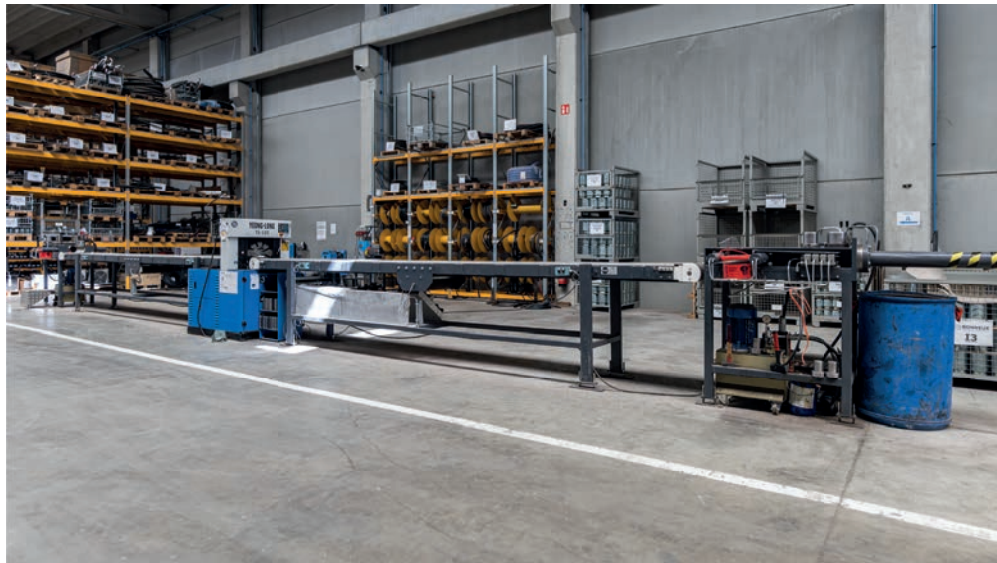
Slangenpers voor het op maat maken van betonslangen
