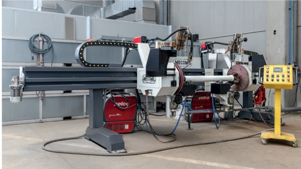
Automatische lasrobot met koeling voor het lassen van enkel- en dubbelwandige betonbuizen
